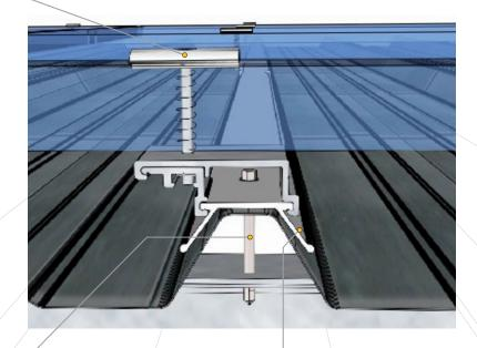
Tirefond unique, pour l'arrimage du bac acier ou du panneau sandwich et du rail d'intégration dans la panne Rail aluminium
